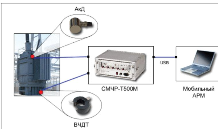
Рис. 1. Схема подключения основных компонентов системы СМЧР-Т500М.
