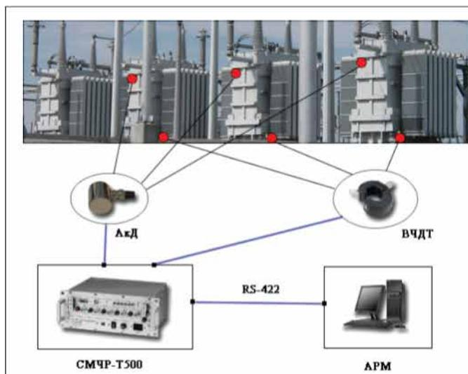
Рис. 1. Схема подключения основных компонентов системы СМЧР-Т500.
