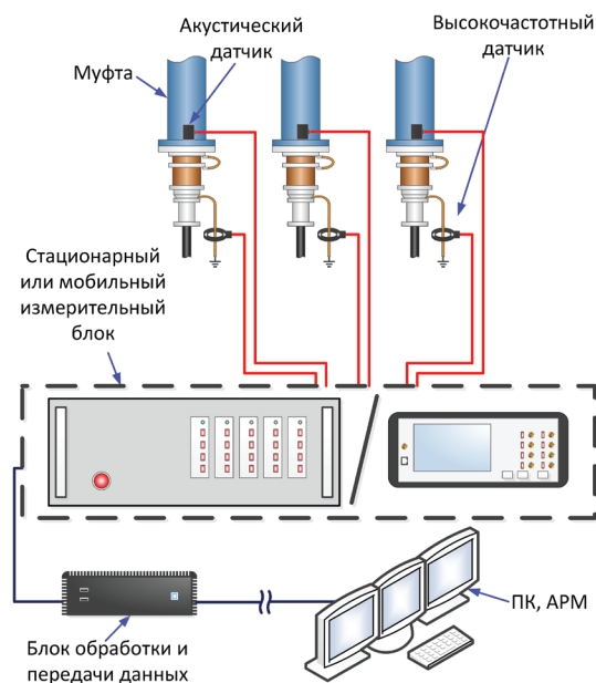
Схема подключения основных компонентов системы СМЧР-КМ.
